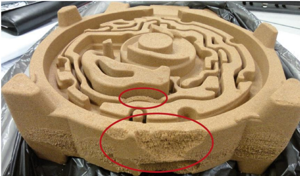
图 10：固化后有缺陷的砂芯。带标记区域表示砂芯未充分固化的部位。
