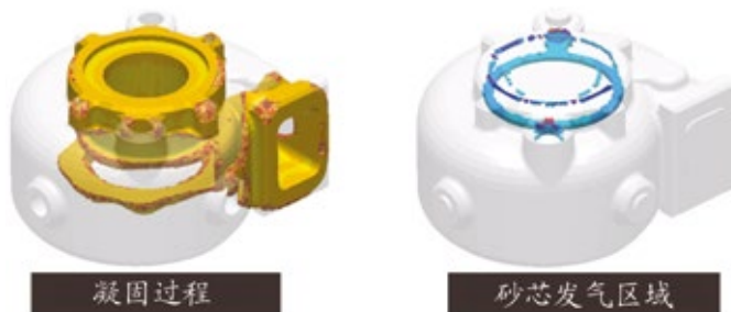
根据局部凝固条件和粘结剂分解情况确定砂芯发气缺陷的危险区域
