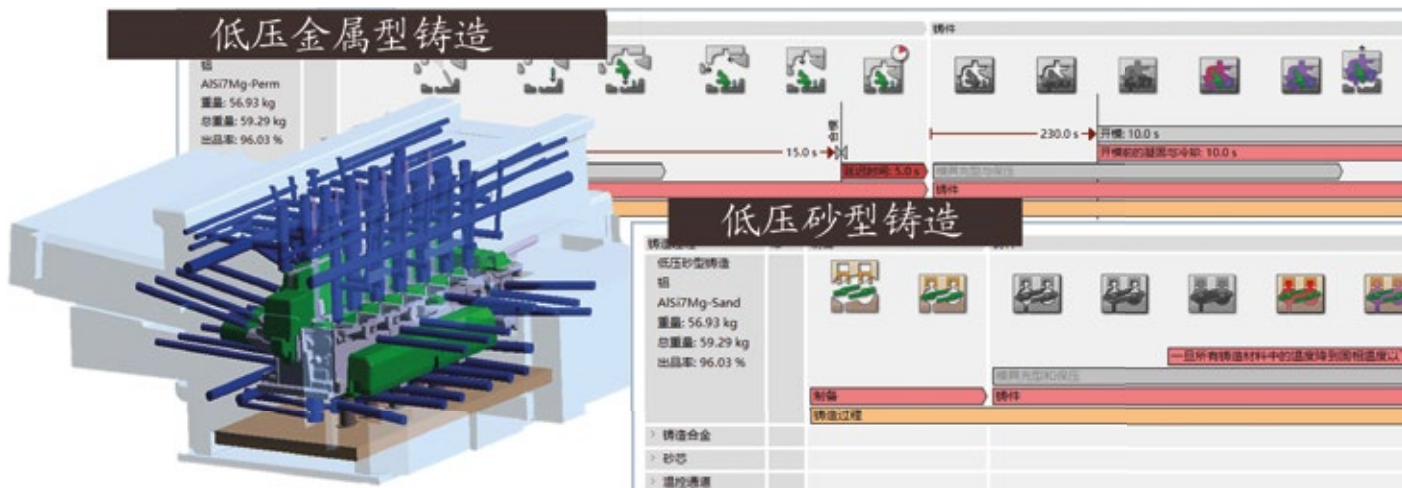
金属型和砂型的低压铸造流程图
