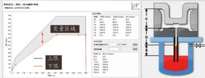
助手支持快速、轻松地估算升液管、铸件和型腔充型的压力条件
