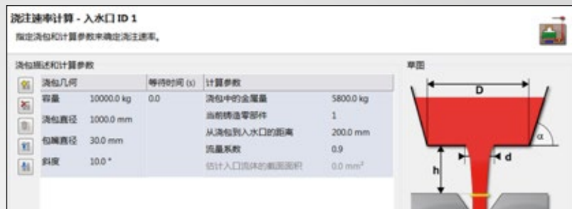
底注式浇包流量 - 根据浇包几何和当前金属液量来计算
