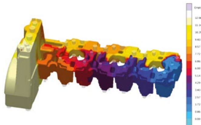
砂粒追踪：分析单个射嘴的砂粒流向和填充量
