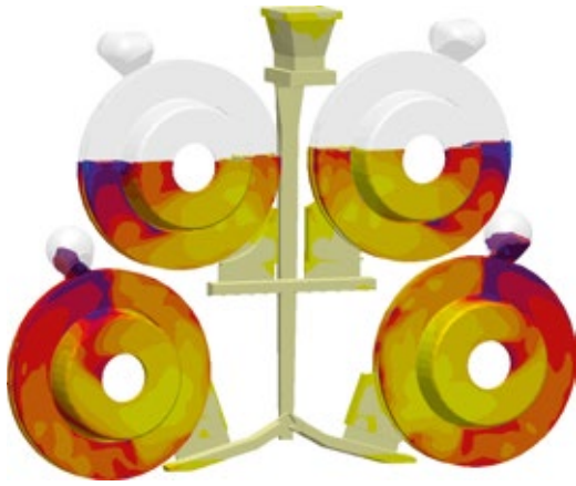
四个灰铁制动盘的充型
