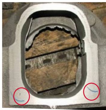
球墨铸铁件局部珠光体含量
