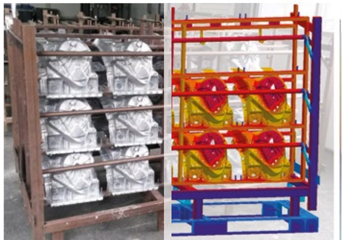
模拟放置在热处理支架上的铸件的真实工艺过程
