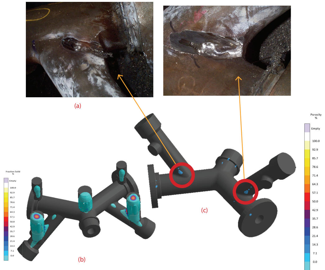
▲ 图11: (a)实际的缩松; (b)凝固结束时的液相分数, 显示孤立的液态区域; (c)缩松结果显示缺陷倾向较高的区域, 并与实际情况吻合。
